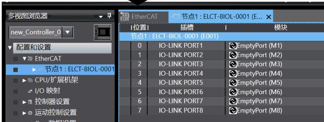
8、此时8个端口上都被“EmptyPort”空端口占用，由于第5端口我们连接了一个16路输入+16路输出的子站，所以选中第5个端口，右键，点击“删除”
