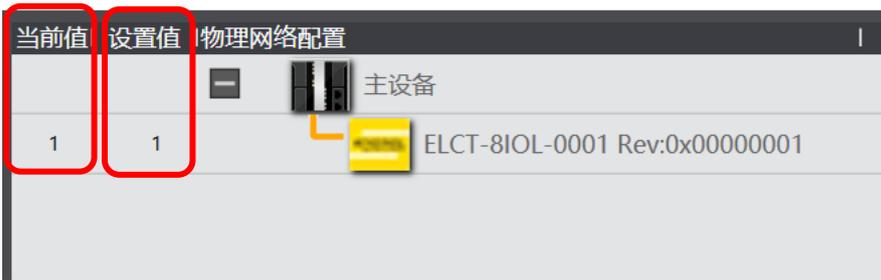
15、此时显示的“当前值”即模块之前的节点地址，此时我们双击“设置值”，修改为之前的设置“8”，修改完正确的模块节点地址后，点击“写入”然后“关闭”即可。写入完成后，模块应该断电重启，此时写入的地址才会生效。
